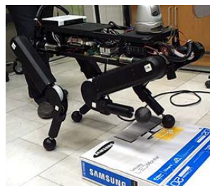
شکل ۱۵: چهارپای TMUBot در حال عبور از مانع [۲۲].
