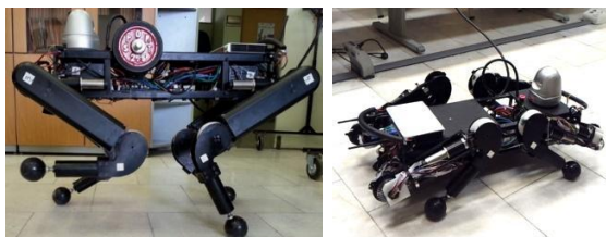
شکل ۱۴: ربات TMUBot در حال نشسته و نیز حرکت پایدار با حمل بار [۲۲].
